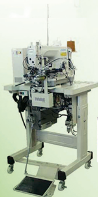
MHA-JBH 200-J Máquina Dobladora de Bota. Producción: 360 botas hora
